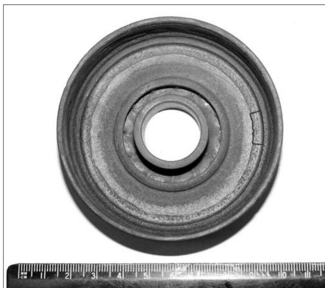
Рис. 7. Канавка после испытаний на верхнем диске направляющего аппарата из опытного низколегированного материала (рамкой выделен участок канавки)
