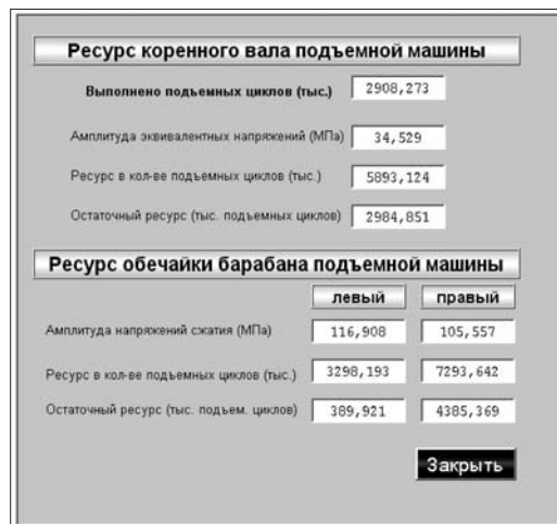
Рис. 4. Экран просмотра нагрузок и ресурса элементов подъемной установки
