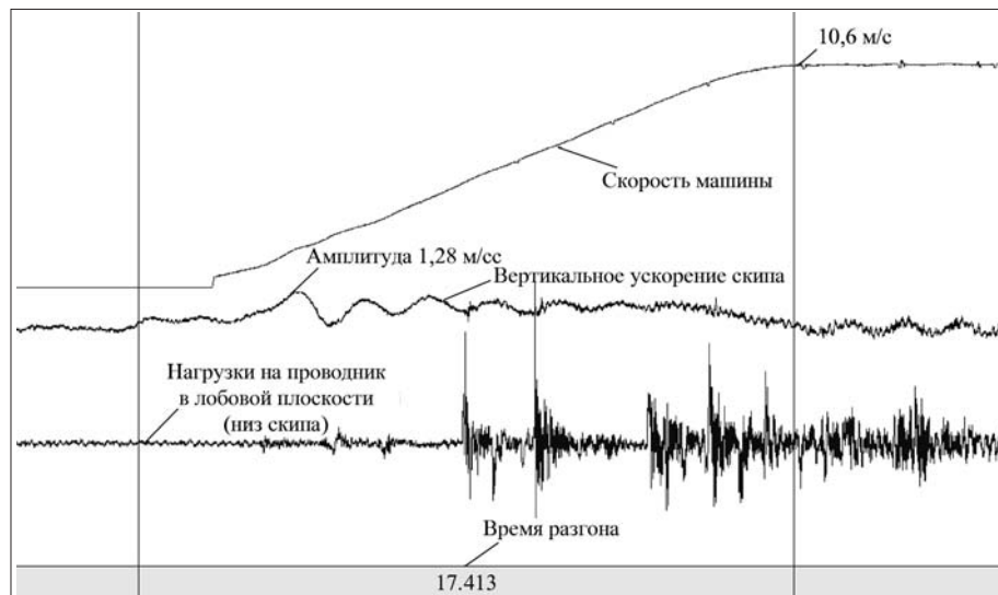
Рис. 5. Та же установка после замены подъемной машины и скипов по данным 2011 г.
